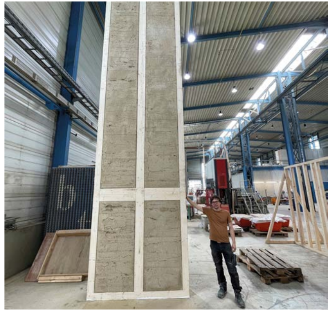
Bild 7 Holz-Lehm-Massivdecke (aus Fließlehm)
