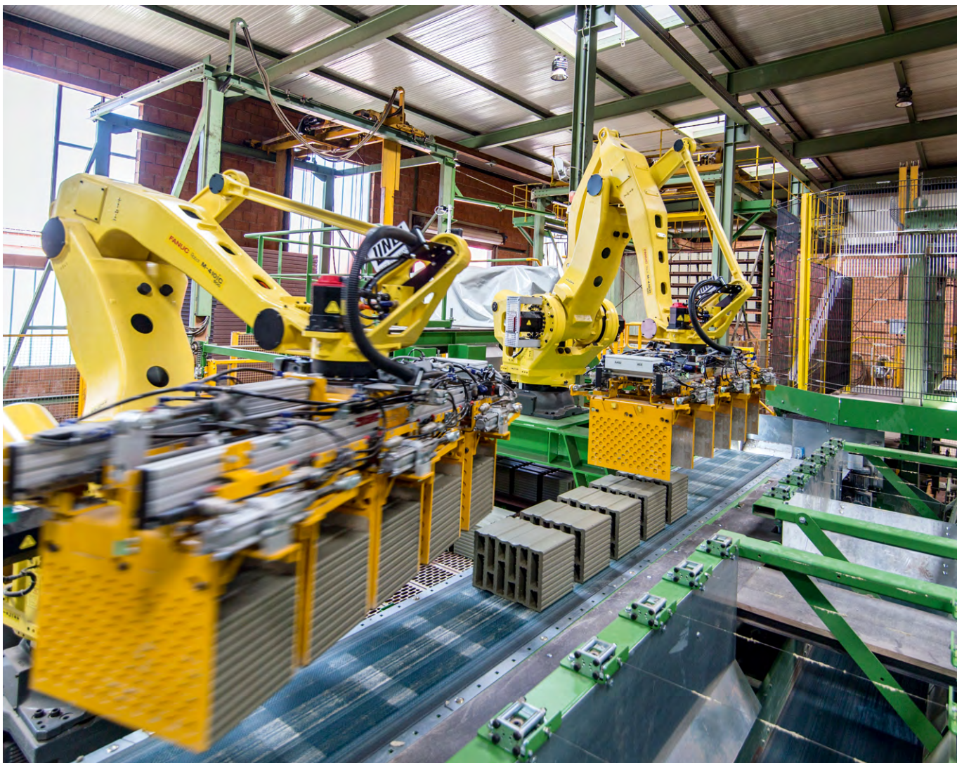
Abbildung 16: Vollautomatisierte Ziegelproduktion; Quelle: Ziegelwerk Klosterbeuren Ludwig Leinsing GmbH + Co. KG
